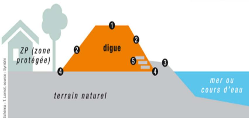
**❶ Crête de digue** supportant généralement une piste. **❷ Talus de digue** : talus aval côté ZP, talus amont côté eau. **❸ Berge**. **❹ Pied de digue**. **❺ Protection anciennes** : perré, lauzes...
